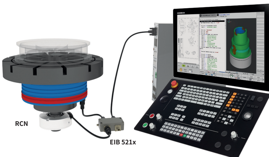
RCN编码器与EIB 521x信号转换器组合
