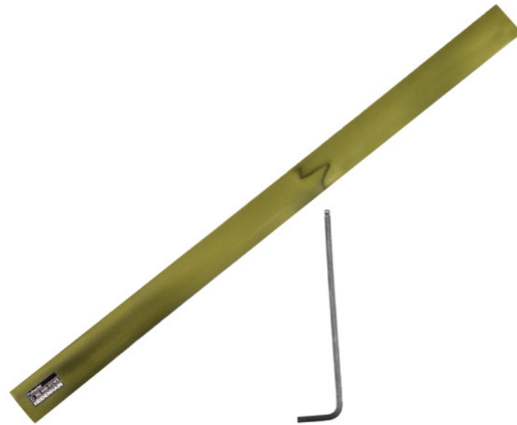
六角レンチと接触させた後、テストフィルムに表示されるマークで磁化の有無を確認
